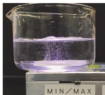
$\text{SrTiO}_3$  ベースの光触媒を塗布したガラス板（2 cm 口くらい）を水を入れたビーカーに入れ、下方から紫外線（LED, 365 nm）を照射している（ムービーのワンカット）。天気が良ければ、太陽光を（上から）あてても気体発生を確認できる。
